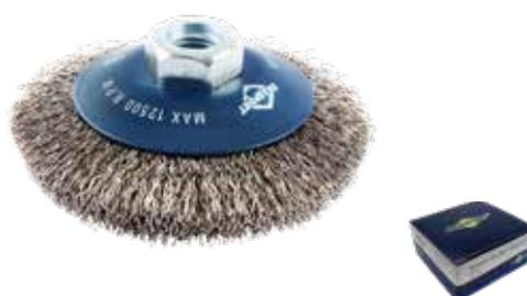
Para utilização em esmerilhadeira. Ideal para arredondar arestas, rebarbar, remoção de tintas e pinturas, desincrustar, remover ferrugem, despolir e limpeza mais pesada. Corpo em aço carbono polido e cerdas em aço carbono. Fio ondulado de 0,30 mm. Rotação máxima: 12.500 rpm.
