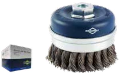
Para utilização em esmerilhadeira. Ideal para arredondar arestas, rebarbar, remoção de tintas e pinturas, desincrustar, remover ferrugem, despolir e limpeza mais pesada. Possui maior durabilidade. Corpo em aço carbono polido e cerdas em aço carbono. Traçado de 0,50 mm. Rotação máxima: 12.500 rpm.
