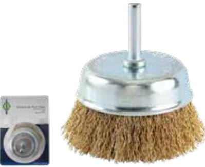
Para utilização em furadeiras. Indicado apenas para limpezas leves. Corpo em aço carbono polido e cerdas em aço carbono. Diâmetro de haste 6 mm. Fio ondulado 0,30 mm. Rotação máxima: 4.500 rpm.
