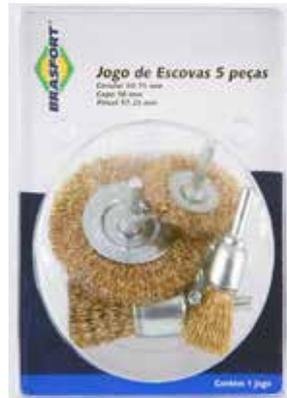
Para utilização em furadeiras e lixadeiras. Indicado para limpeza de ferrugem. Atinge diversas regiões de difícil acesso. Indicado apenas para limpezas leves. Corpo em aço carbono polido e cerdas em aço carbono. Fio ondulado de 0,30 mm. Rotação máxima: 4.500 rpm.
