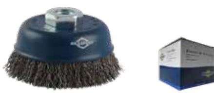
Para utilização em esmerilhadeira. Ideal para arredondar arestas, rebarbar, remoção de tintas e pinturas, desincrustar, remover ferrugem, despolir e limpeza mais pesada. Corpo em aço carbono polido e cerdas em aço carbono. Fio ondulado 0,30 mm. Rotação máxima: 8.500 rpm.
